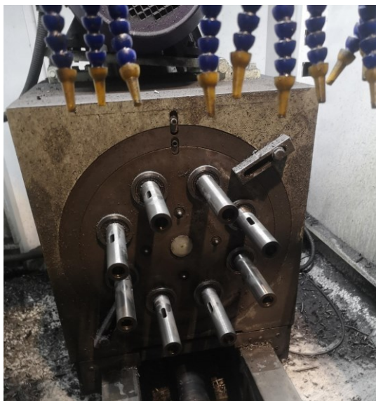
Slika 71 Glava za bušenje prije čišćenja
