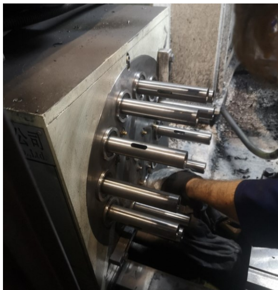
Slika 73 Čišćenje glave za bušenje
