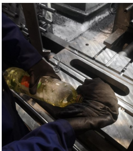
Slika 72 Nanošenje sredstva za čišćenje na krpu
