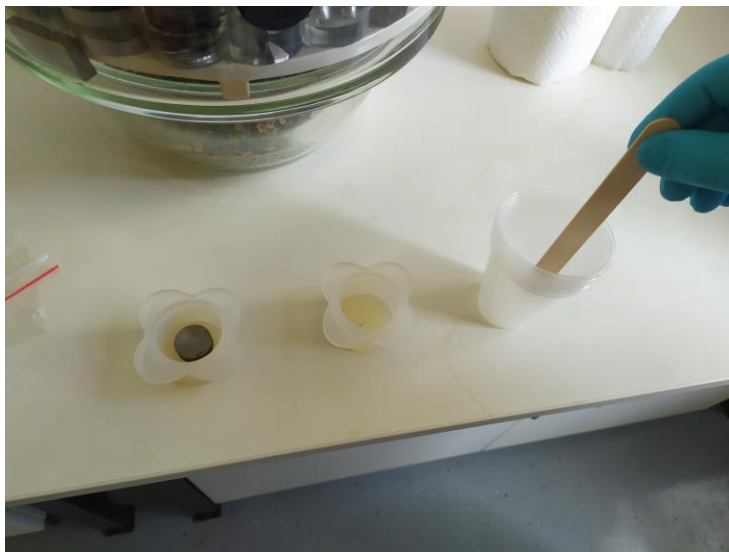
Slika 27. Pozicioniranje uzorka i ulijevanje smole u kalup
