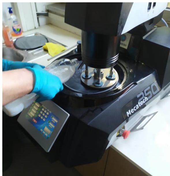
Slika 31. Ručno dodavanje SHIP-a tijekom poliranja
