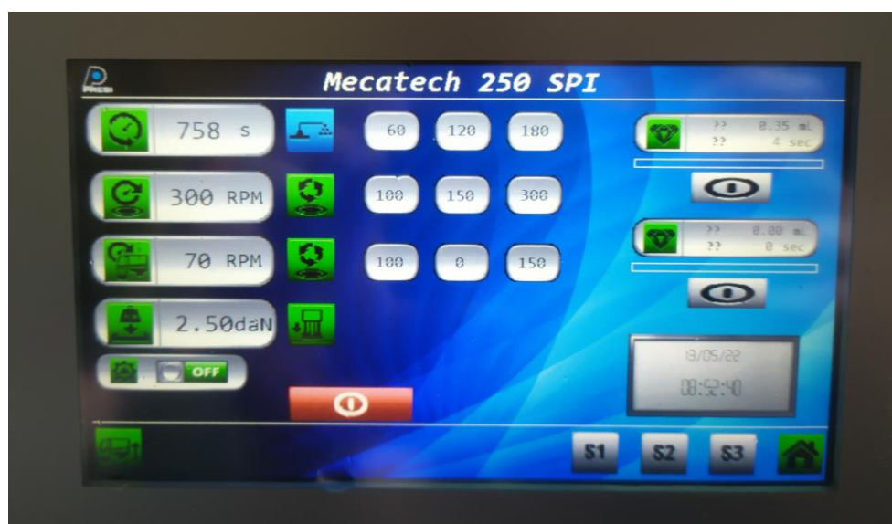
Slika 30. Sučelje upravljačke ploče stroja tijekom rada
