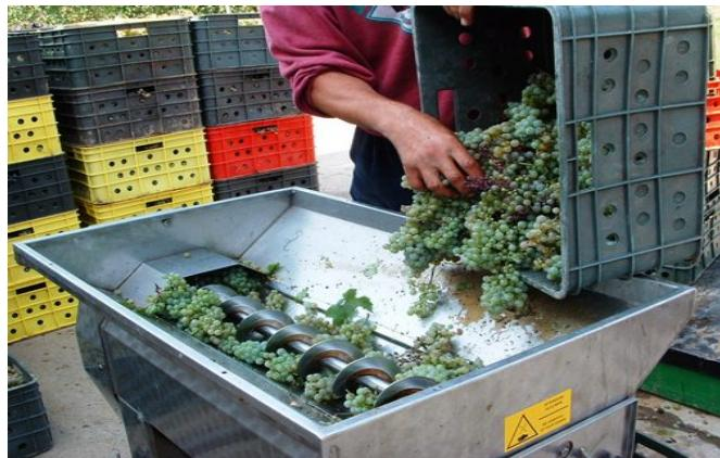
*Slika 7. 3.2. Fotografija runjače – muljače*
