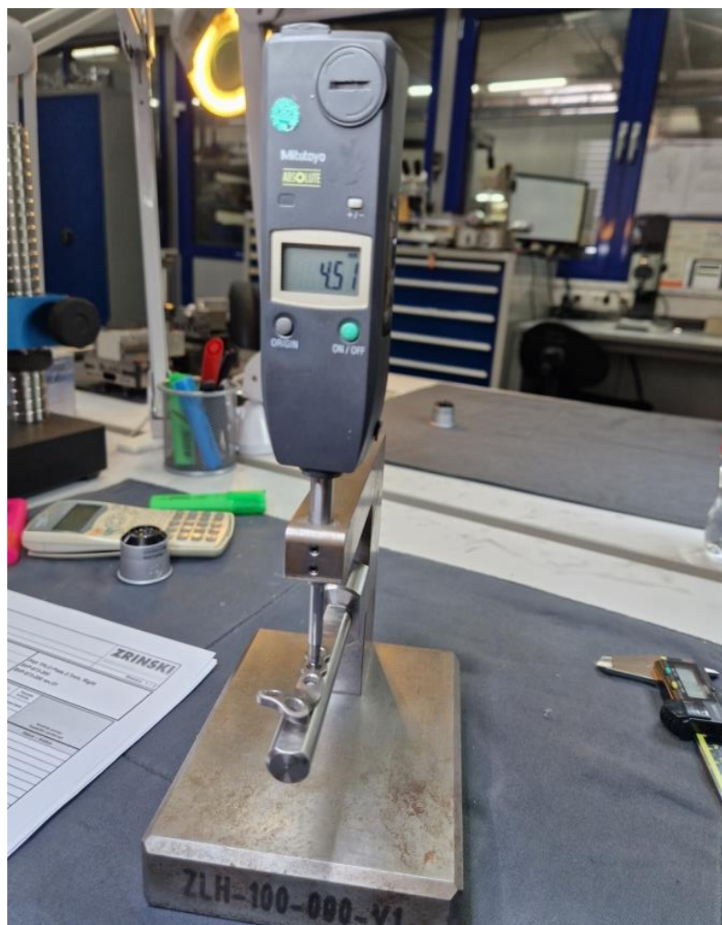
Slika 42. Mjerenje rupa ("cvjetova")
