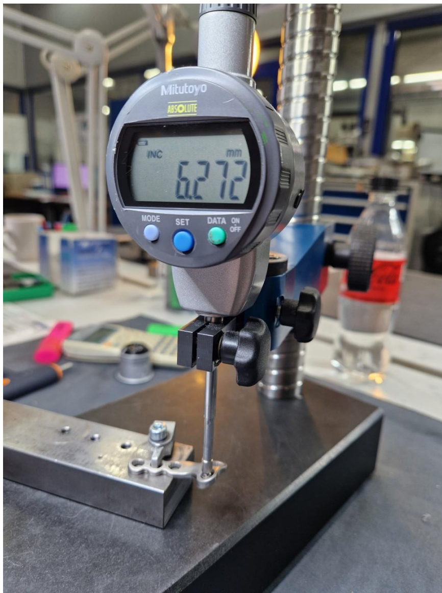
Slika 37. Mjerenje visine kuglice
