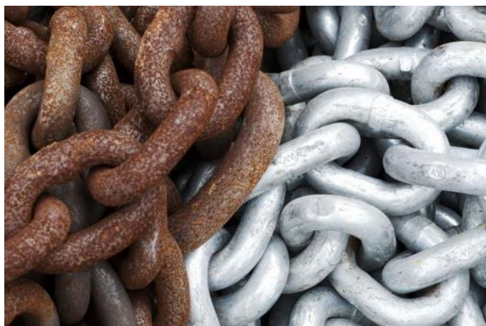
Slika 3.2 Lanac uslijed djelovanja korozije[11]
