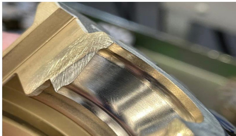
Slika 18. Primjer otpadanja metalizacije [27]
