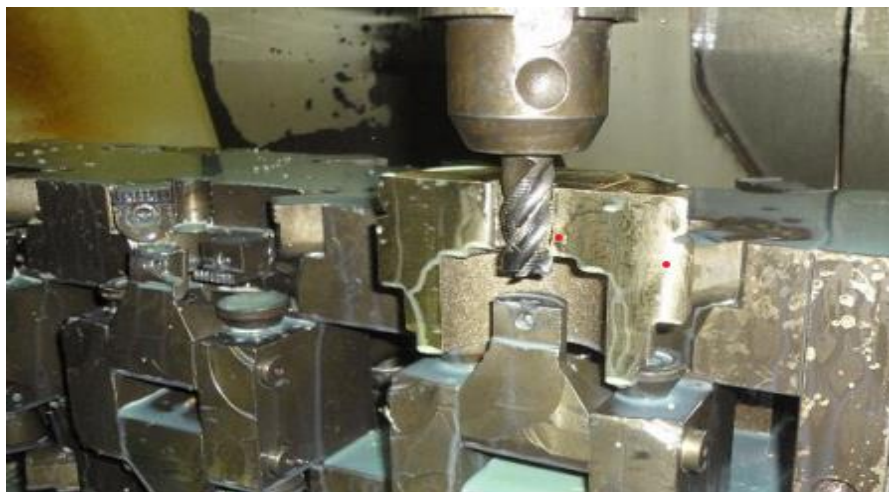
Slika 21. Glodanje promjera do metalizacije [27]
