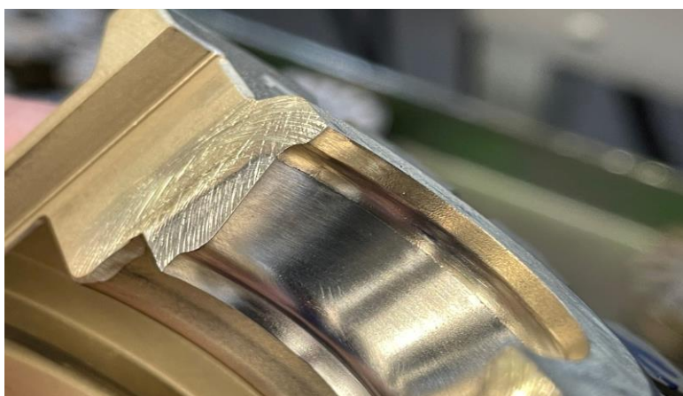
Slika 18. Primjer otpadanja metalizacije [27]
