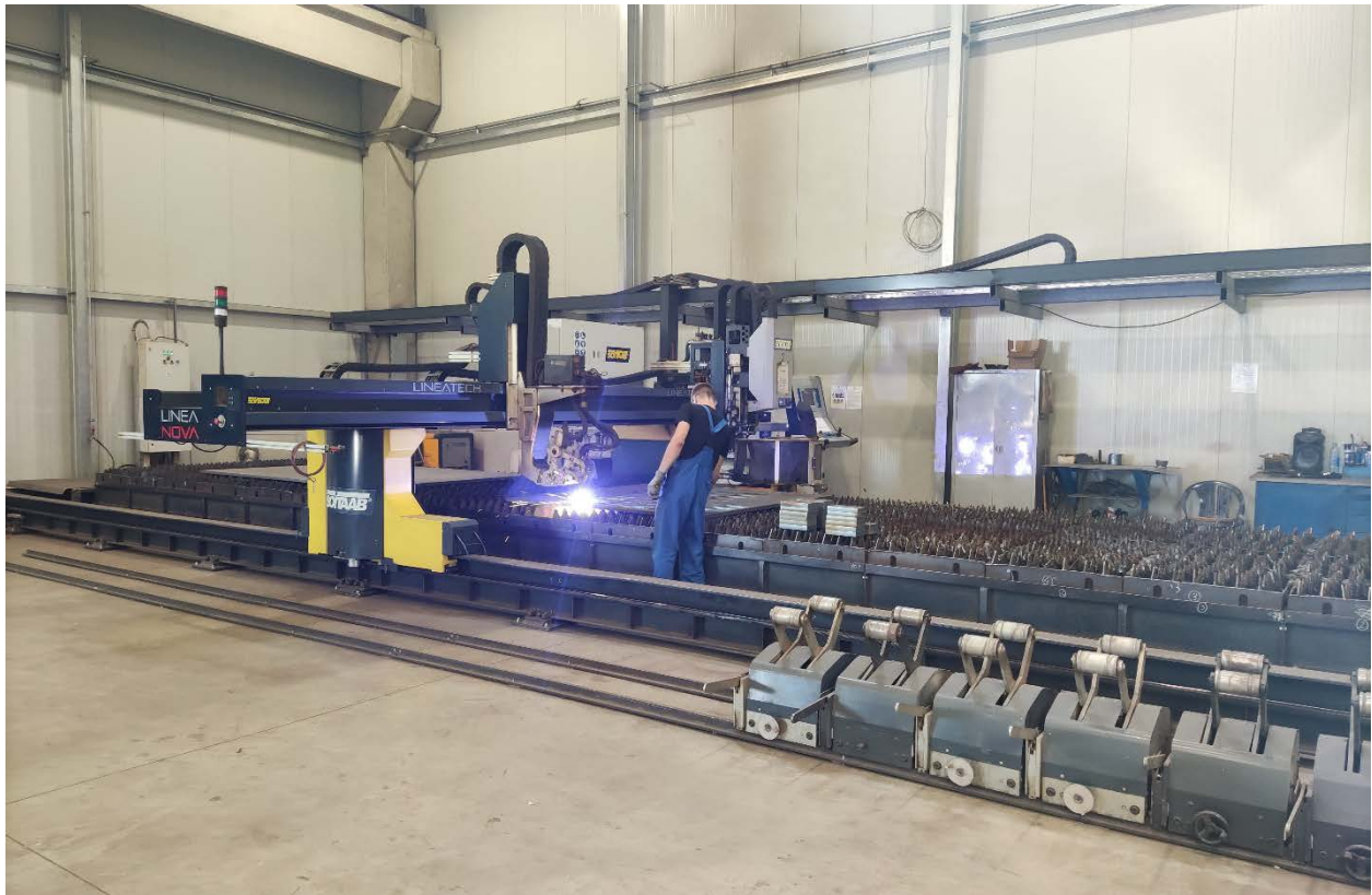
Slika 26. Proces plazma rezanja na stroju Soitaab Impianti SRL [28]
