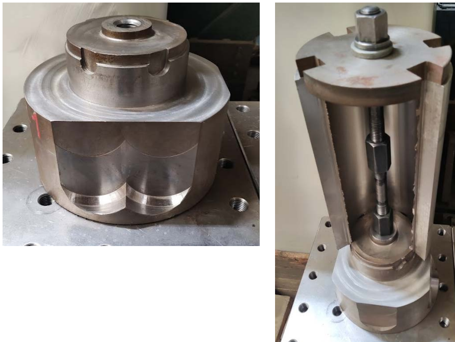
Slika 42. Naprava za stezanje (lijevo) i naprava zajedno sa stegnutim obradkom (desno) [28]
