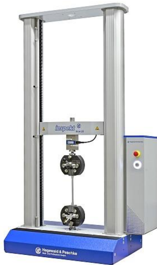
Slika 2.2 Primjer univerzalne kidalice [4]
