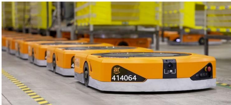
Slika 34: Skladišni robot u Amazonu
