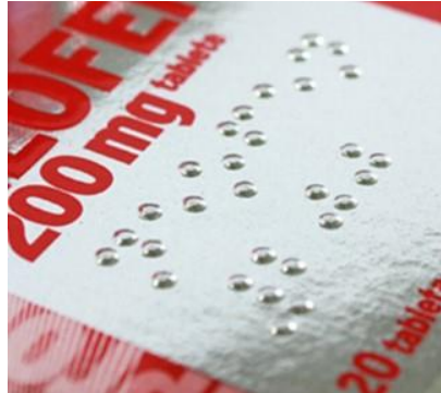
Slika 3.18 Otisnuto Brailleovo pismo na komercijalnoj kutiji lijeka
