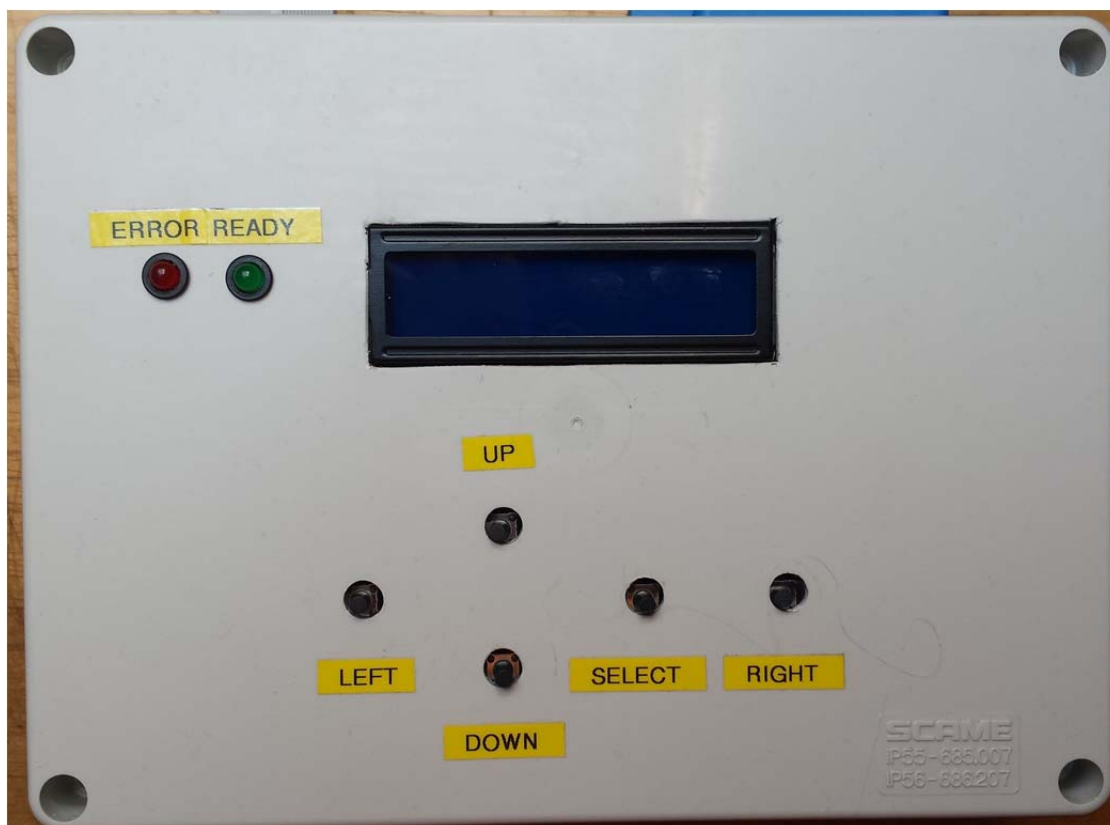
Slika 12: Upravljačka jedinica sustava upravljanja – prednja strana
