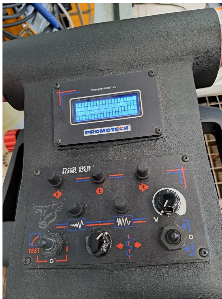
Slika 7.6 Upravljačka ploča Promotech Rail Bull traktora s led zaslonom (fotografirano na Sveučilištu Sjever)
