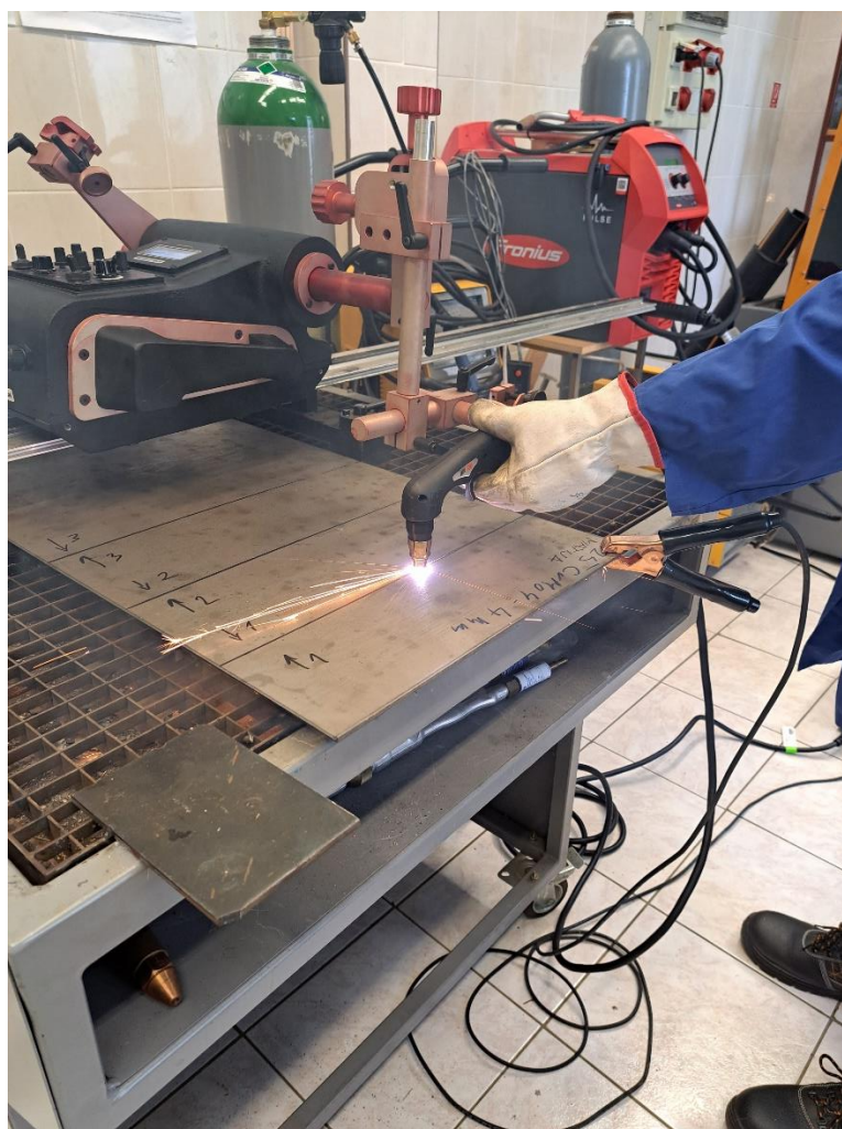
Slika 7.10 Materijal nakon rezanja na tri segmeneta (fotografirano na Sveučilištu Sjever)
