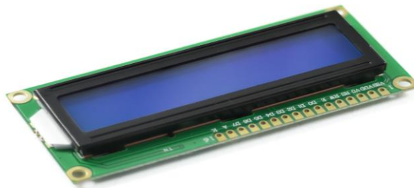
Slika 10. LCD 16x2 zaslon [10]
