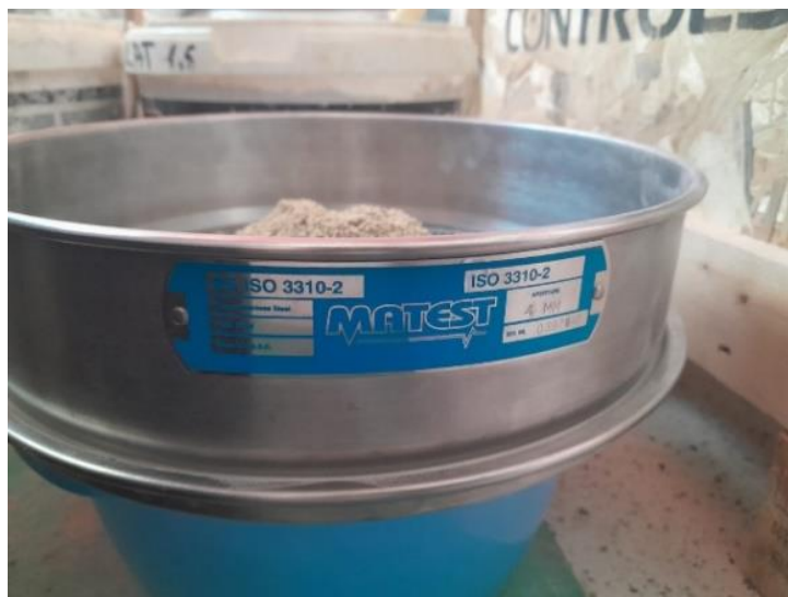
Slika 4.1 Prosijavanje pepela kroz sito otvora 1 mm
