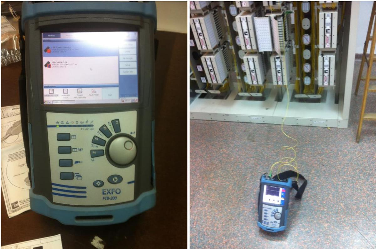
Slika 5.1. Mjerni instrument EXFO FTB-200 (izvor: autor)
