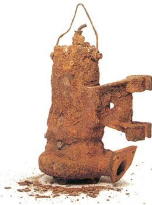
Slika 4.10 Primjer opće korozije pumpe od ljevanog željeza [22]
