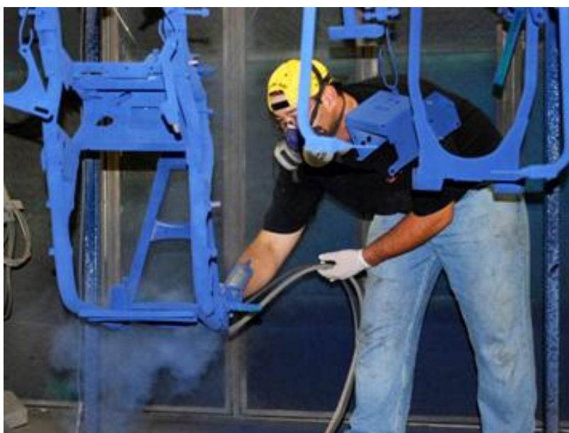
Slika 5.14 Postupak plastificiranja metala [50]
