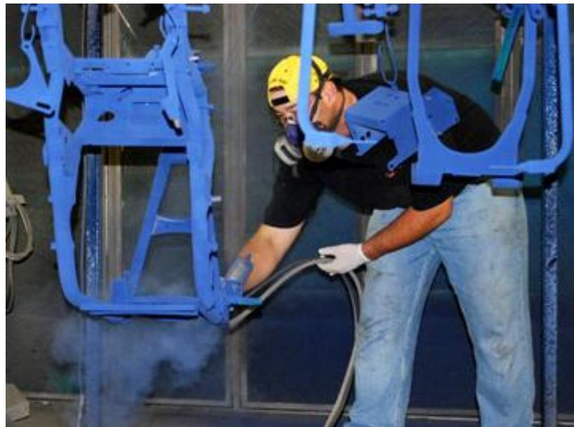
Slika 5.14 Postupak plastificiranja metala [50]
