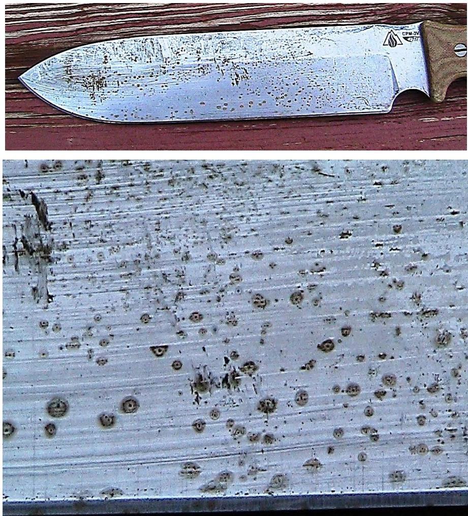
*Slika 4.12 Primjer pjegaste korozije na oštici noža [23]*
