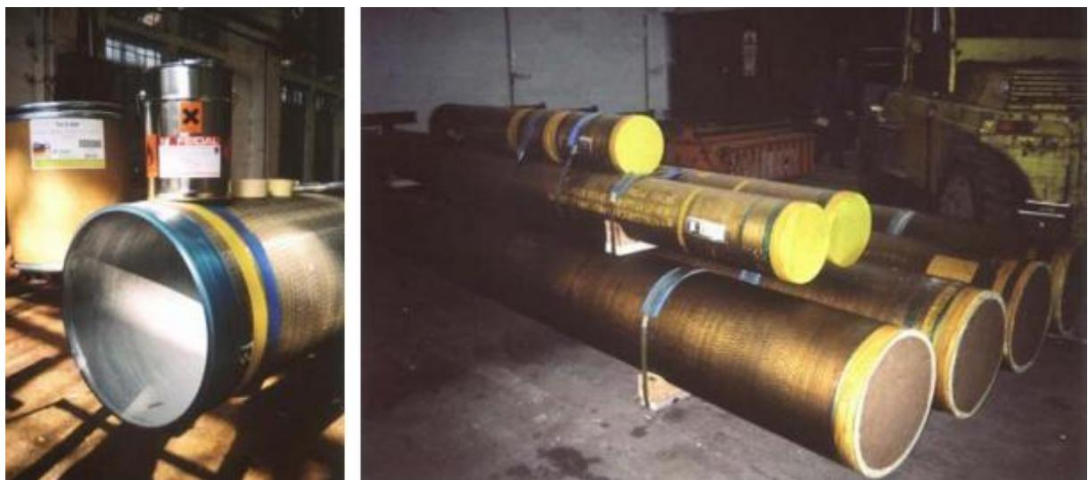
Slika 5.25 Privremena zaštita unutrašnjosti cijevi praškastim inhibitorima [55]
