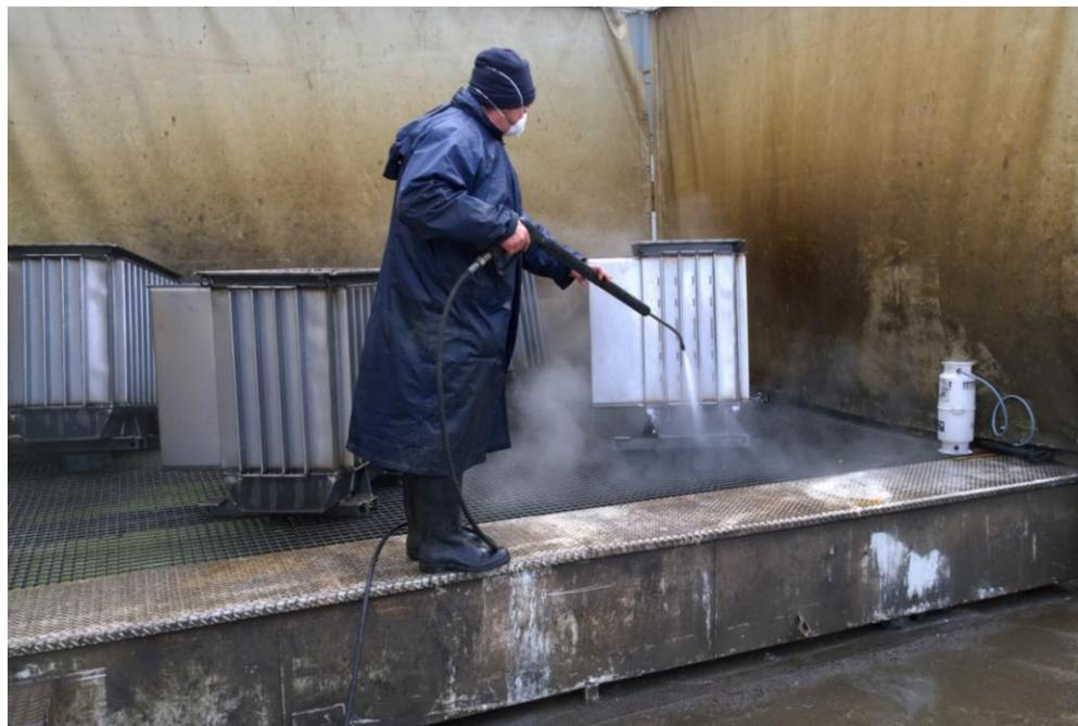
Slika 5.4 Odmašćivanje visokotlačnim prskanjem
