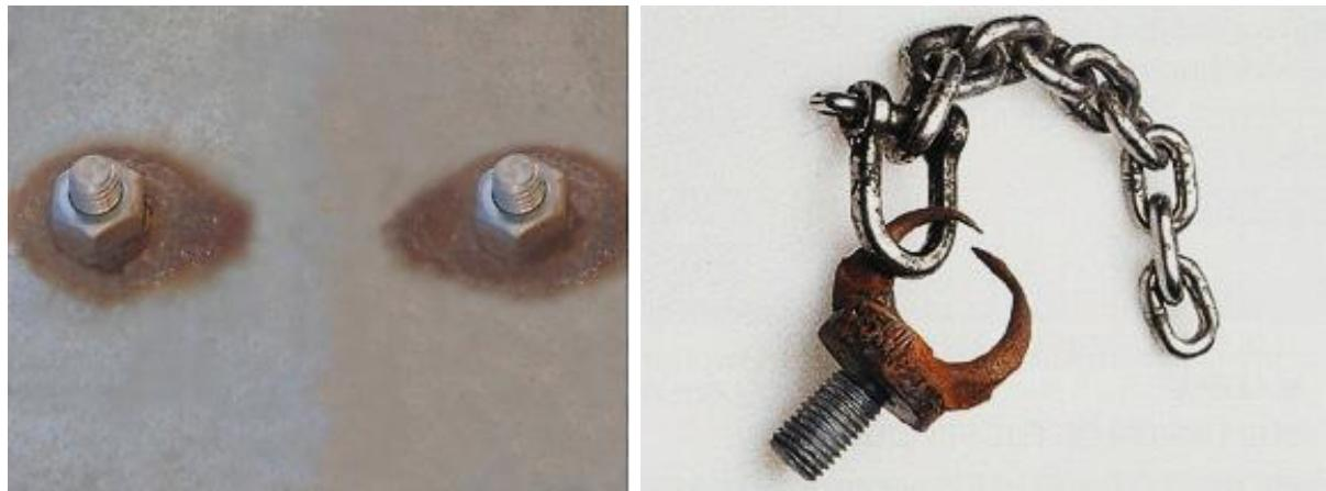
*Spoj matice i plemenitije podloge podloge (lijevo), povezanost čeličnog vijka s inoks materijalom [12]*
