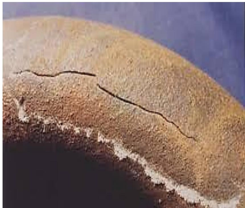
Slika 4.20 Primjer napetosne korozije ugljičnog čelika [34]
