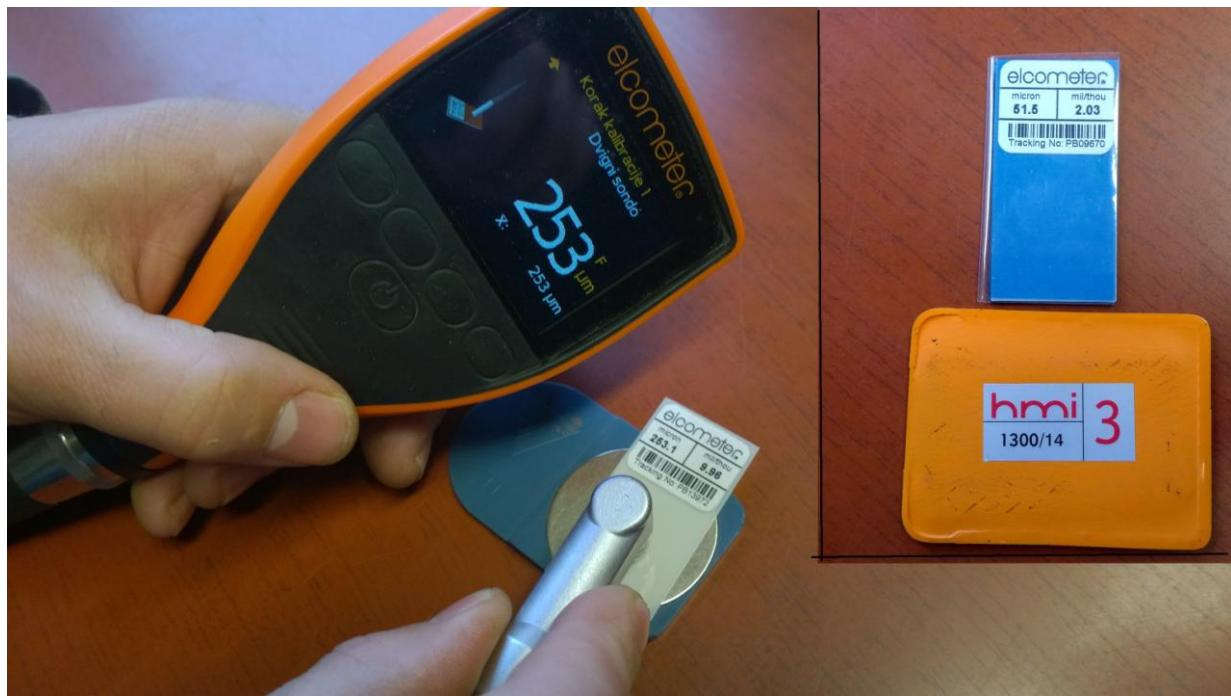
Slika 6.21 Kalibriranje prije završnog ispitivanja
