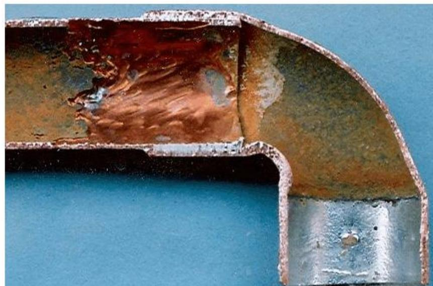
Slika 4.24 Primjer erozijske korozije unutarnje stjenke bakrenog cjevovoda [35]
