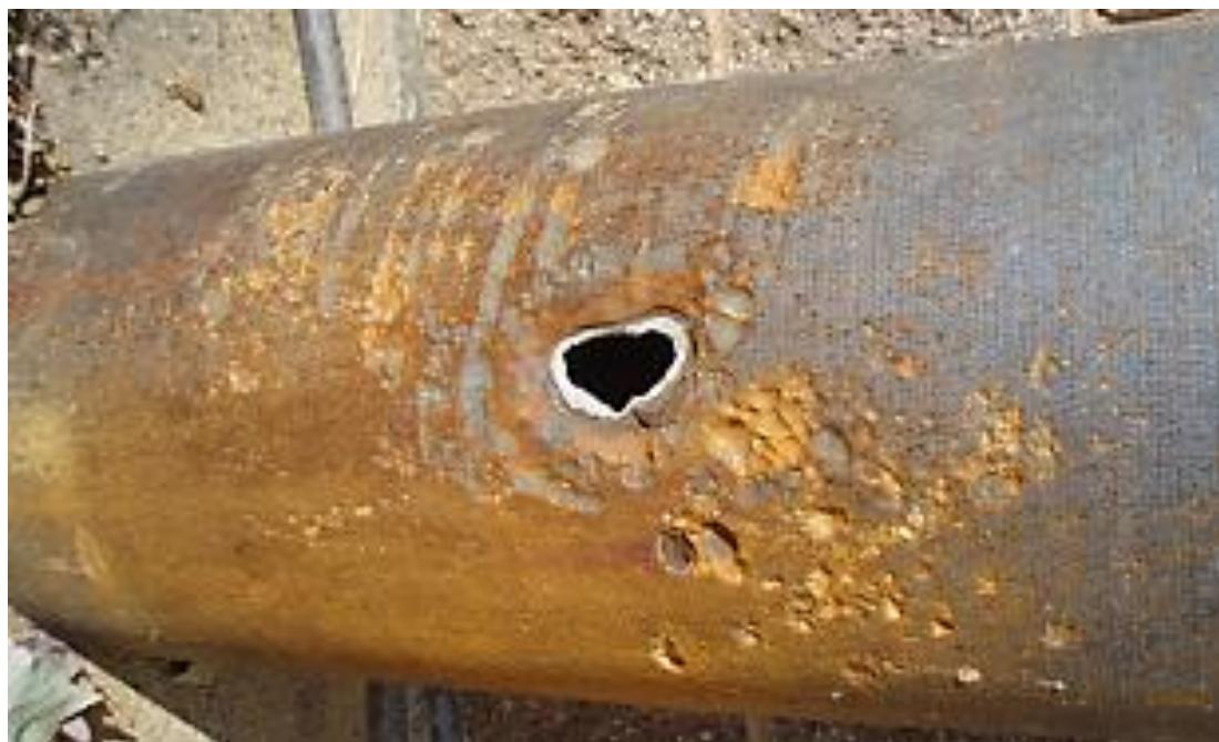
Slika 4.13 Primjer rupičaste korozije- probušeni cjevovod[24]
