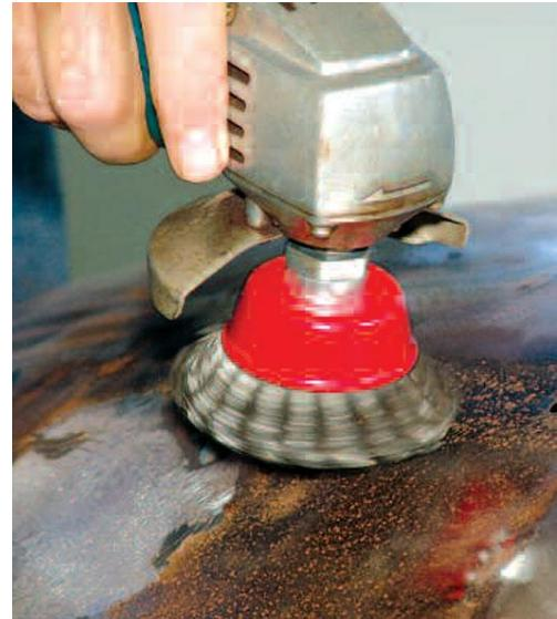
Slika lijevo prikazuje brušenje brusnim papirom, a slika desno žičanom četkom
