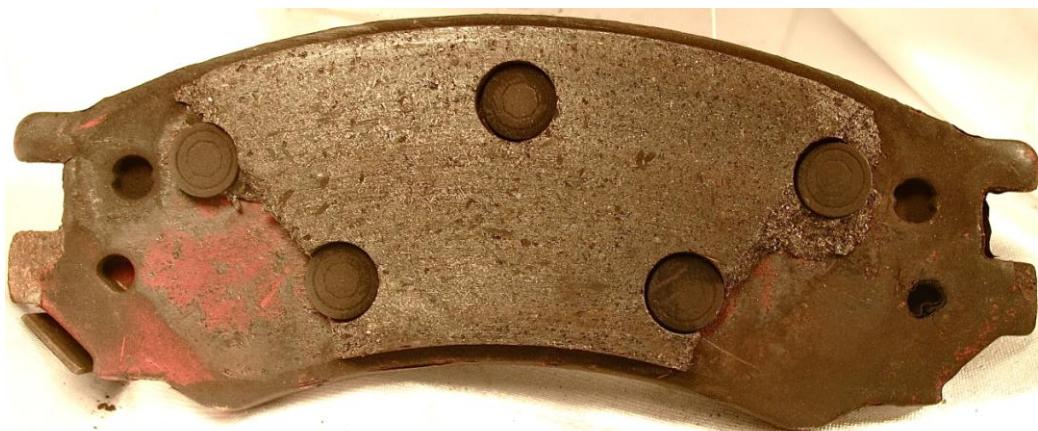
*Slika 4.26 Primjer korozije uzrokovane trenjem kod automobilskih kočnica[36]*
