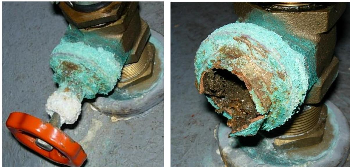
Slika 4.17 Usljed dezincifikacije mjerdi dolazi do puknuća ventila [31]
