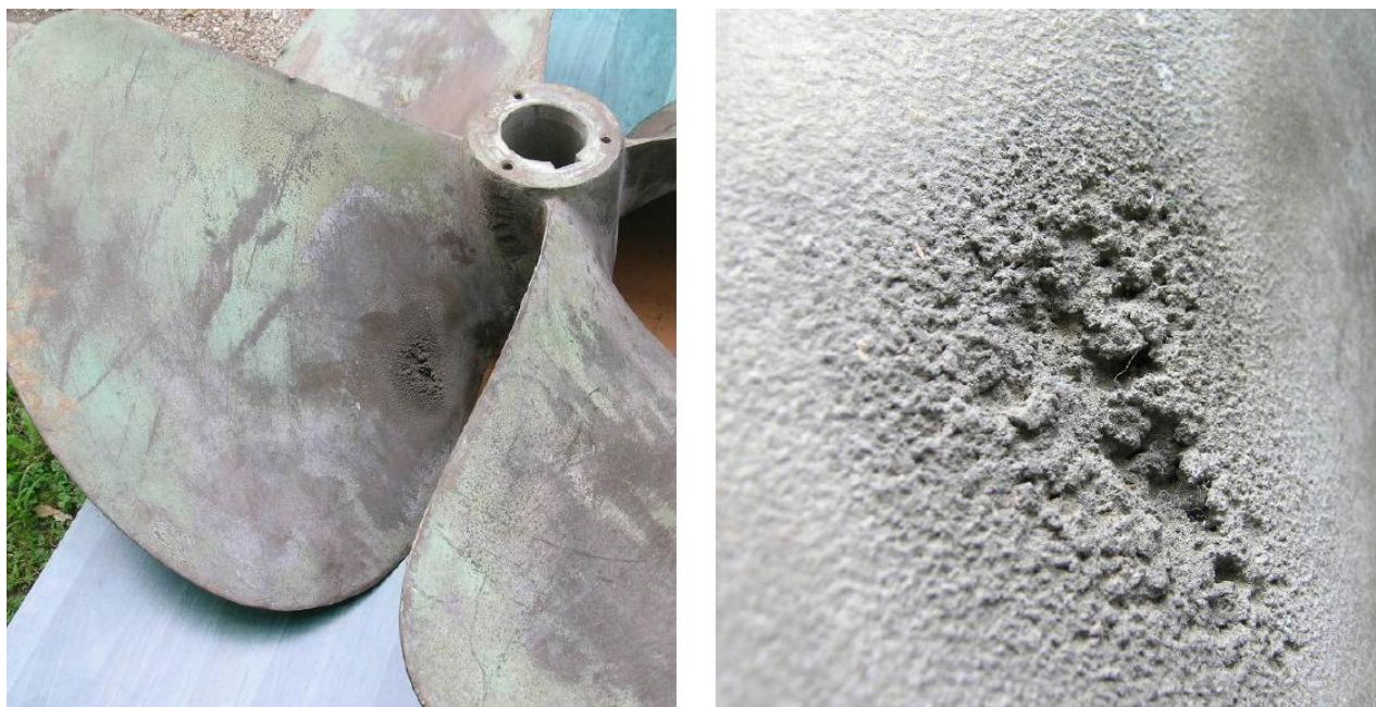
Slika 4.25 Primjer kavitacijske korozije krila brodskog vijka [35]
