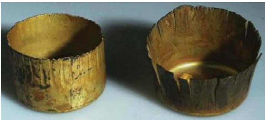
Slika 4.22 Primjer napetosne korozije čahure streljiva [34]
