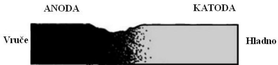
Slika 4.23 Primjer principa termogalvanske korozije [9]
