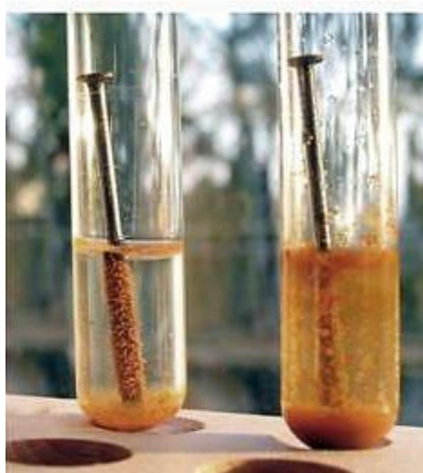
*Slika 4.8 Izgled novih željeznih čavala nakon 7 dana stajanja u običnoj (lijevo) i slanoj vodi (desno) [17]*
