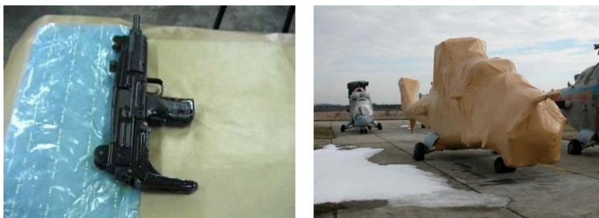
Slika 5.24 Primjena inhibitora korozije u vojnoj industriji [55]
