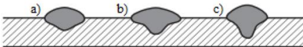
Slika 8.7 Utjecaj jakosti struje na zavar [18]
