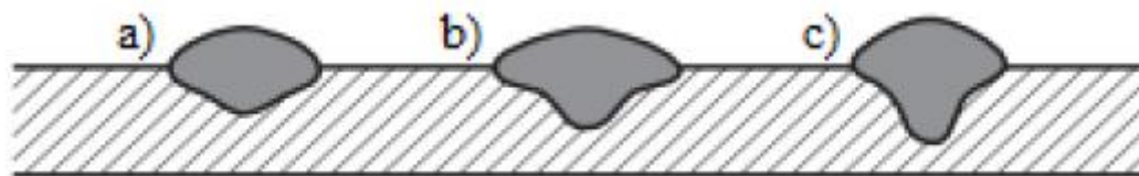
Slika 8.7 Utjecaj jakosti struje na zavar [18]
