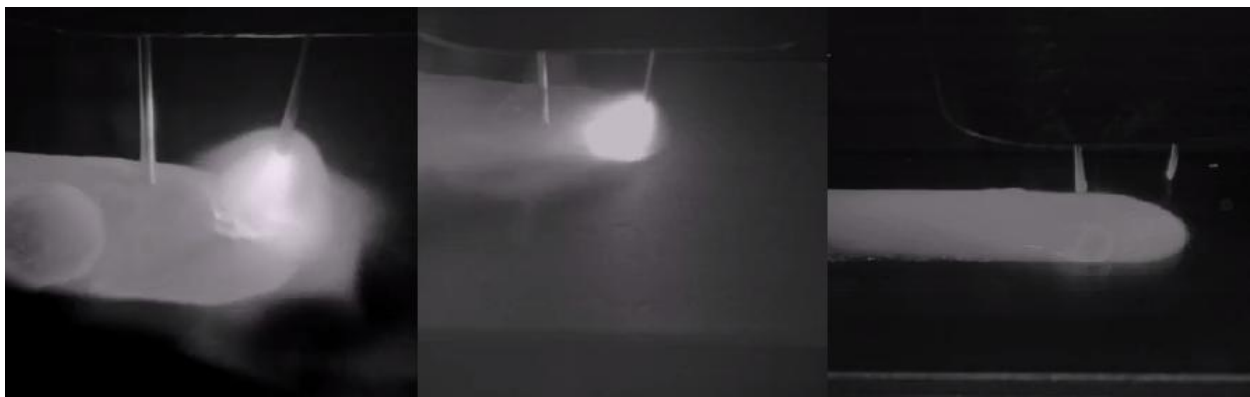
Slika 10.3 Realni prikaza prijenosa metala kod tandem zavarivanja [29]
