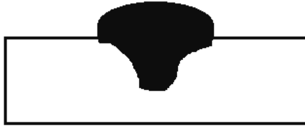
Slika 6.1 Utjecaj zaštitnog plina argona na geometriju zavara
