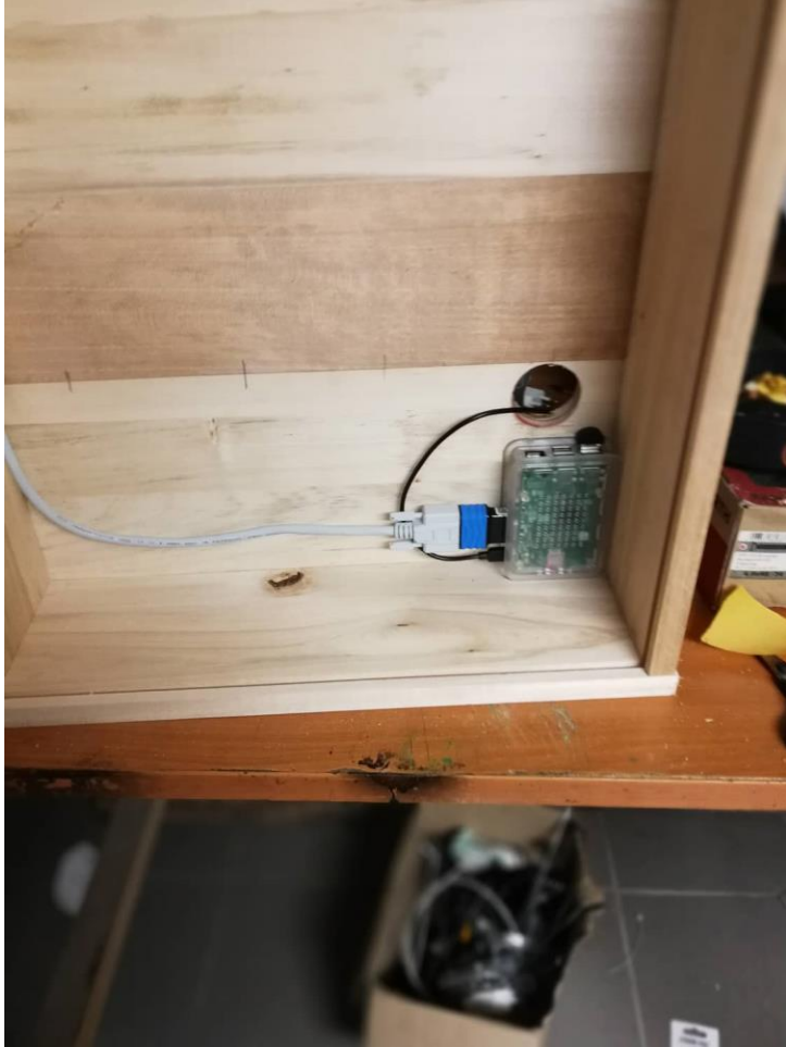
Slika 15: pričvrščen raspberry pi na konstrukciju
