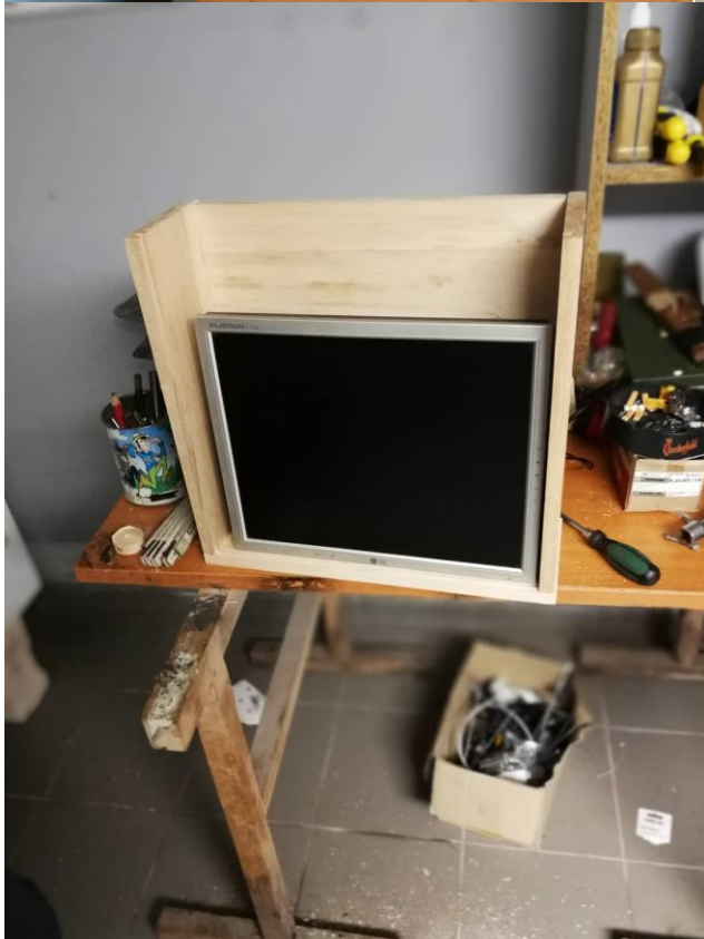
Slika 16,17 i 18: odvajanje postolja monitora te prčvrščivanje na konstrukciju
