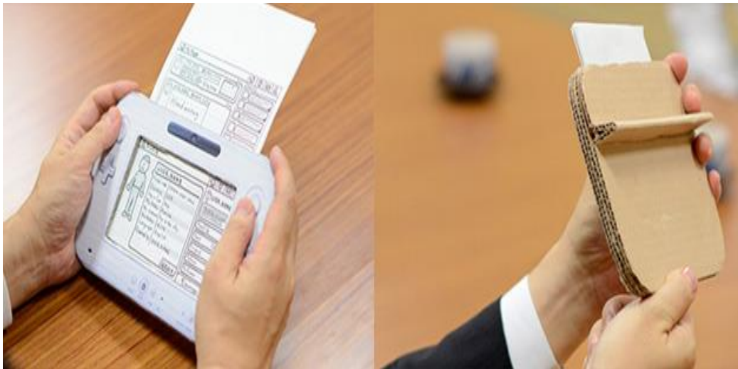
Slika 10. Low fidelity papirnati prototip (Rani prototip Nintendo wii U)
