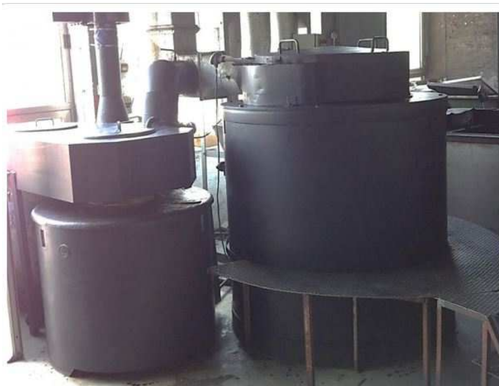
Slika 4. Solna kupka za nitrokarburiranje TENIFER [9]
