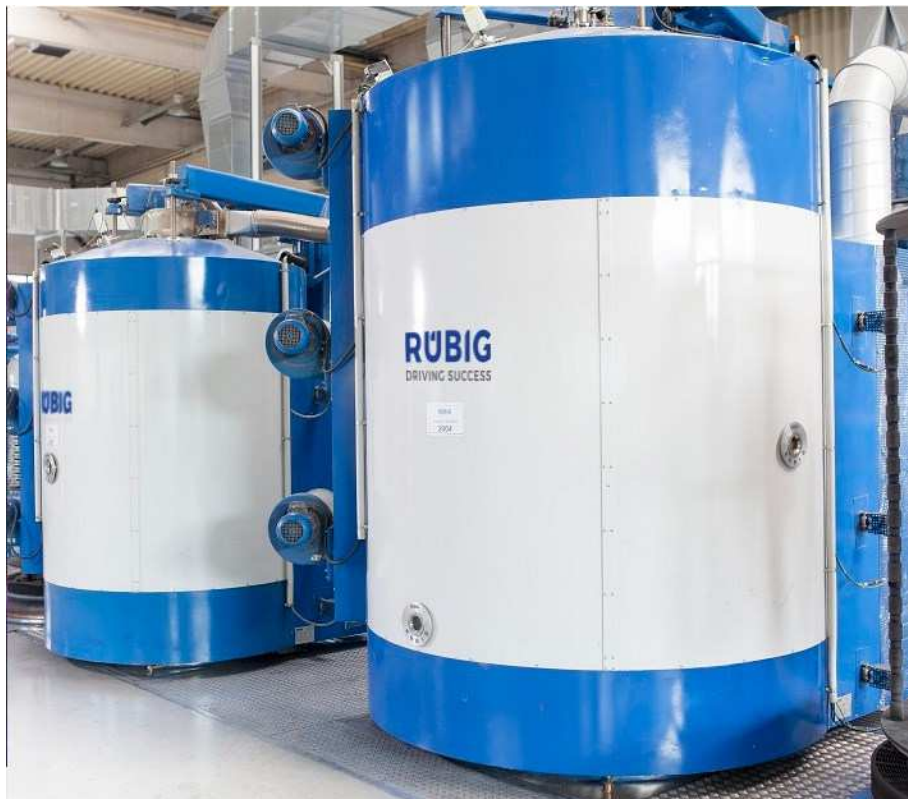
Slika 8. Vakuumska komora za postupak PLASOX [14]
