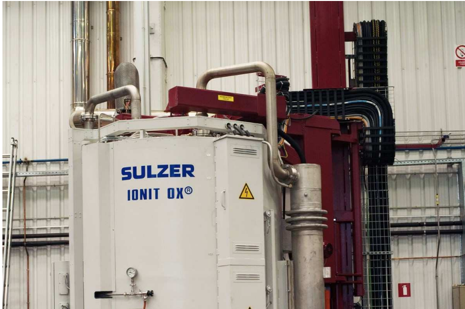
Slika 11. Peć za IONIT OX ® nitrokarburiranje tvrtke "Sulzer" [16]
