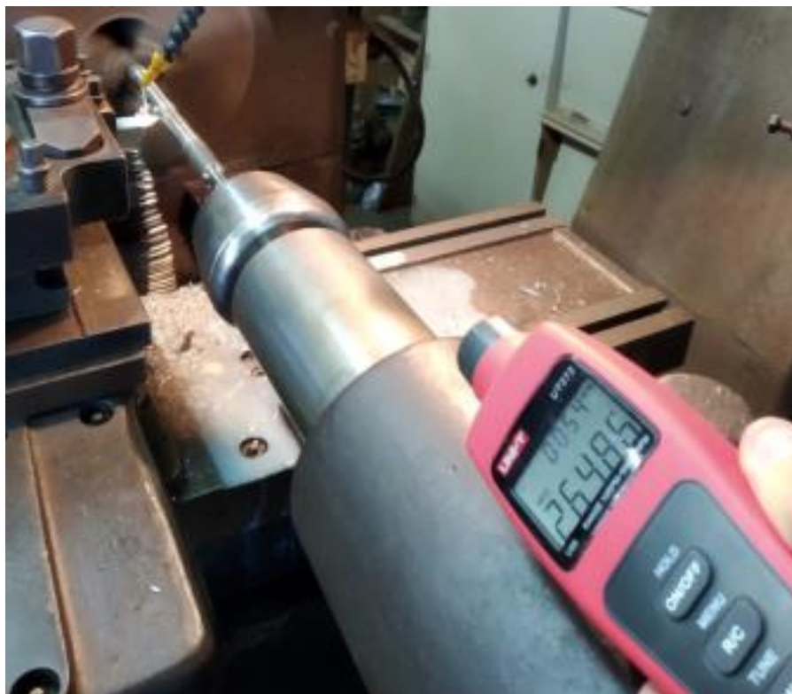
Slika 33. Tahometar mjeri brzinu vrtnje na steznoj glavi
