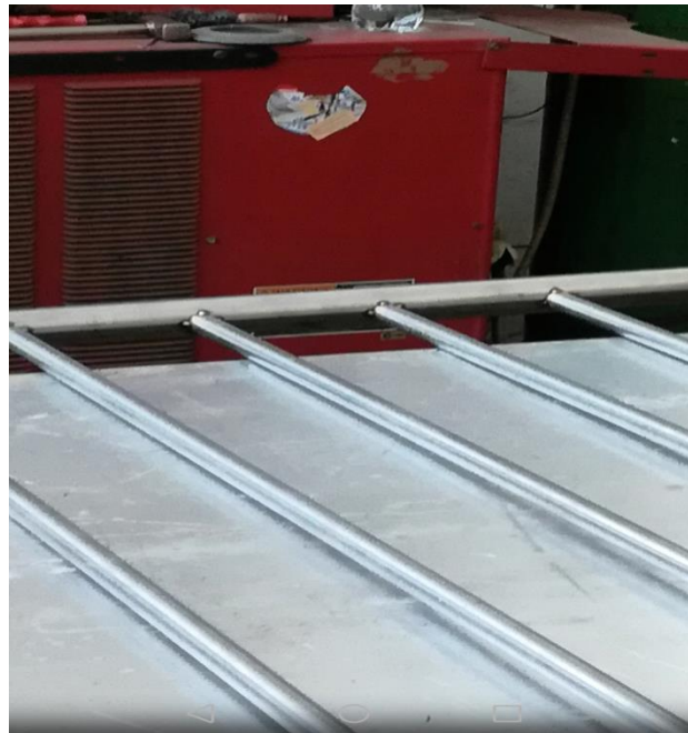
Slika 21. Puntiranje bez dodatka žice
