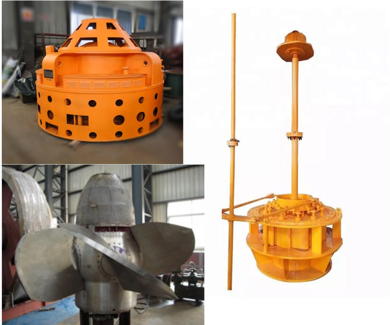
Slika 44. Prikaz dijelova turbine ZDT03-LM(Y)-120 i generatora SF250-16 [36]
