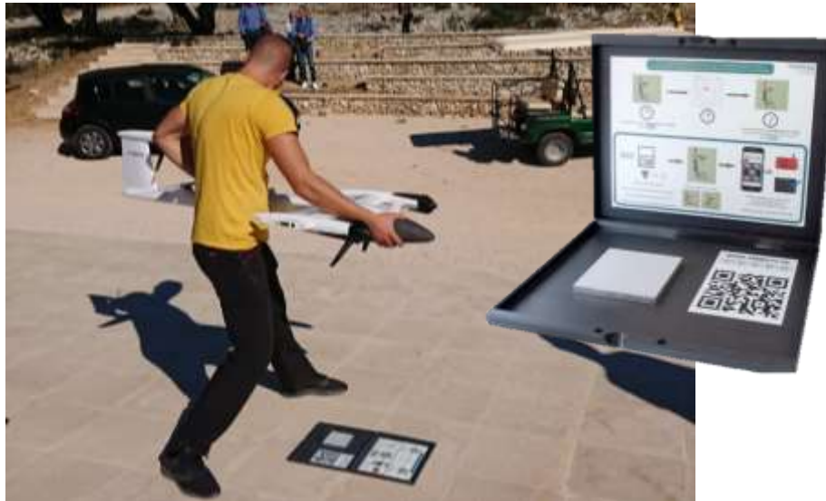
Slika 14. Kalibracija postavljenog MS senzora pomoću kalibracijskog referentnog panela
