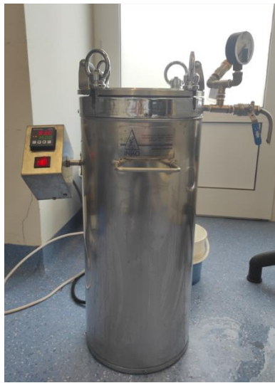
Slika 5. Sterilizacija hranjive podloge u autoklavu (Izvor: J.Lončar, 2023.)
