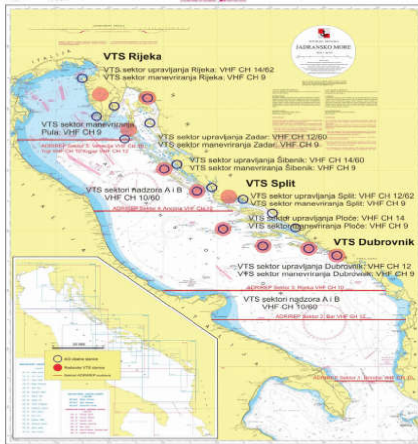
Slika 9. Radarska i AIS pokrivenost hrvatskog VTS područja, radijska VHF pokrivenost VTS sektora, sektori i radijska pokrivenost ADRIREP sustava.
