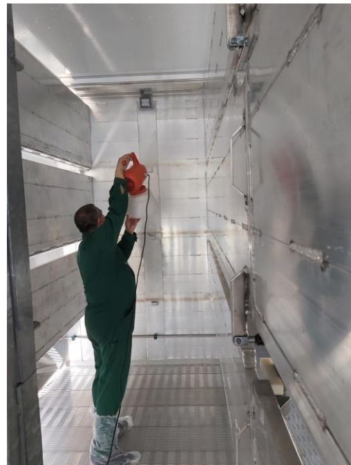
Slike 3. i 4. Dezinfekcija motornom ULV prskalicom do orošavanja
