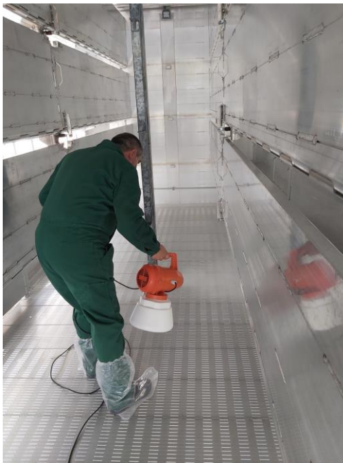
Slike 3. i 4. Dezinfekcija motornom ULV prskalicom do orošavanja
