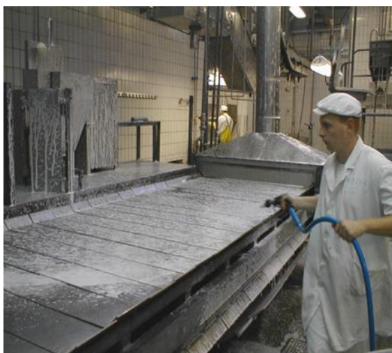
Slika 9. Prikaz korištenja pjenušavog sredstva u klaoničkom objektu.
