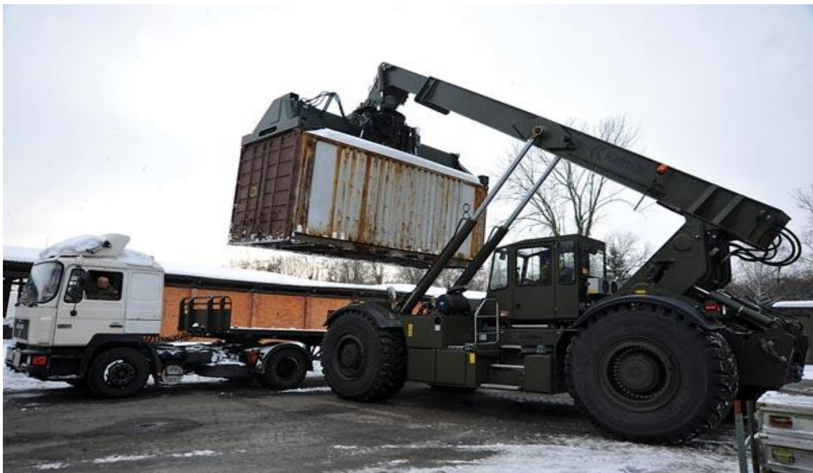
Slika 20. Stavljanje kontejnera na tegljač s poluprikolicom
