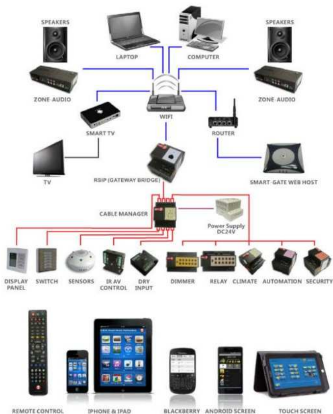
Slika 17: Povezivanje uređaja u pametnom domu
