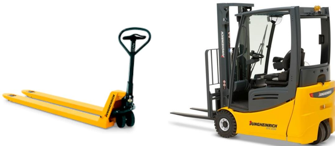
**Slika 18. Ručni i električni viličar s pokretnim vilicama**
