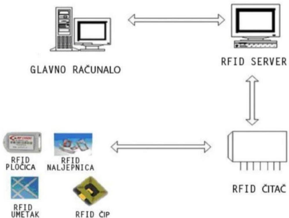
**Slika 25. RFID princip**
