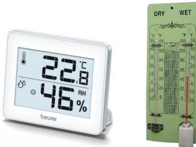
Slika 9. Higrometar i psihrometar
