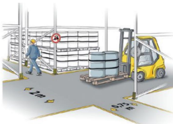
Slika 6. Prometnice u skladištu
