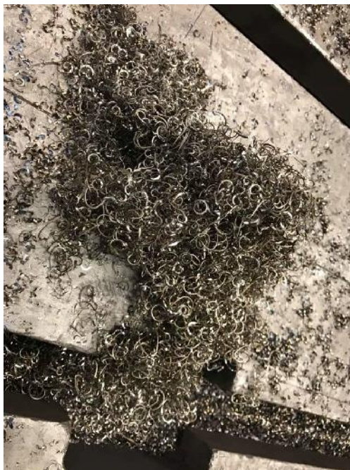
Slika 13. Strugotina nastala prilikom obrade metala
