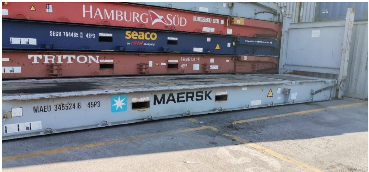
Slika 10. Flat Rack kontejner
