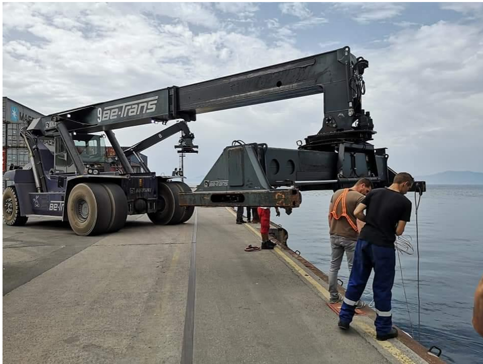
Slika 20. Autodizalica- Reach Staker
