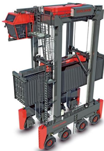
Slika 17. Portalni prijenosnik malog raspona
