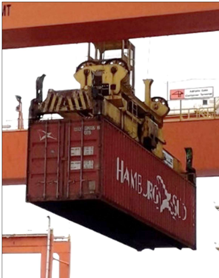
Slika 7 - Hvatač (Spreader) u radu AGCT -Luka Rijeka
