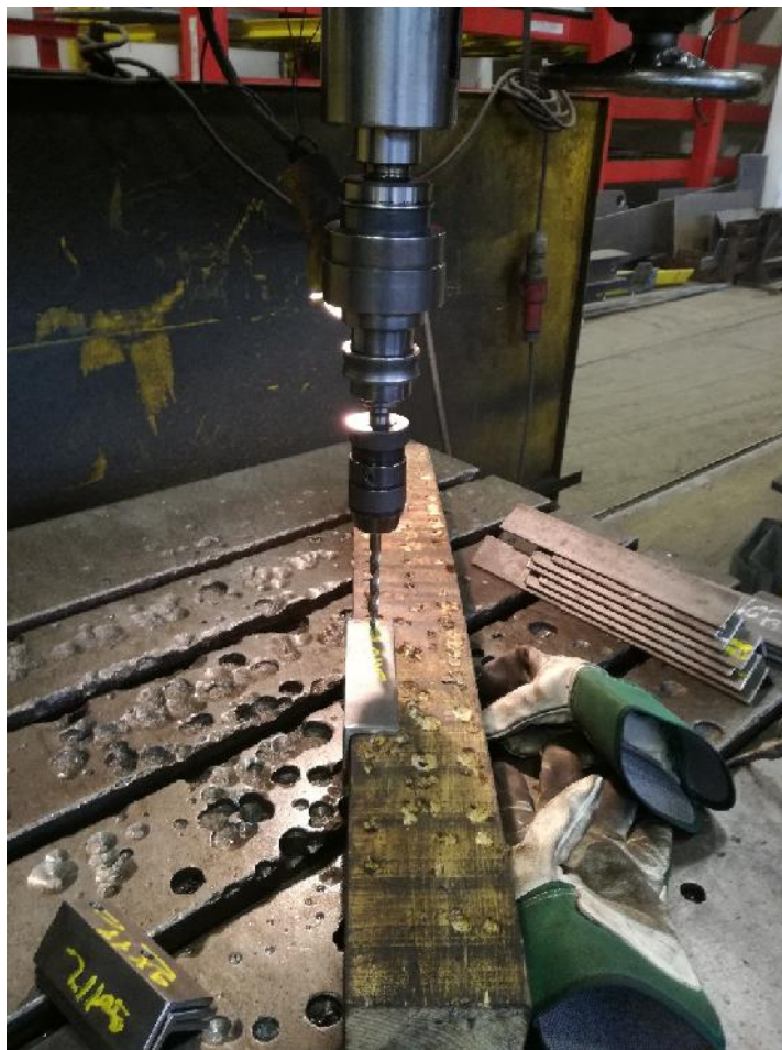
Slika 6. Bušenje manjih provrta na metalnoj plo ici na stolnoj bušilici
