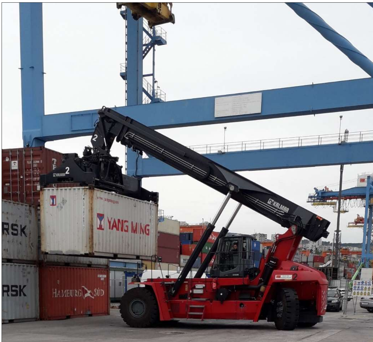
Slika 10 - Viličar s hvatačem (spreanderom) na terminalu AGCT u radu
