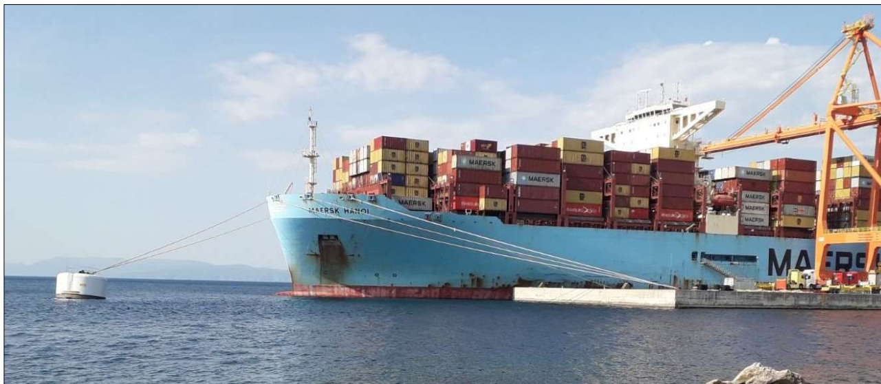
Slika 22 - Priveza broda za plutaču
