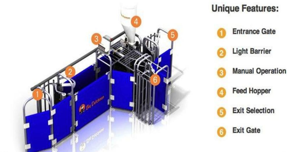
Slika 14. Shema hranidbene postaje Big Dutchman Callmatic sa 1.) ulaznim vratima, 2.) senzorom, 3.) računalom za ručne postavke, 4.) hranilicom, 5.) selekcijskim izlazom i 6.) izlaskom nazad u boks.
