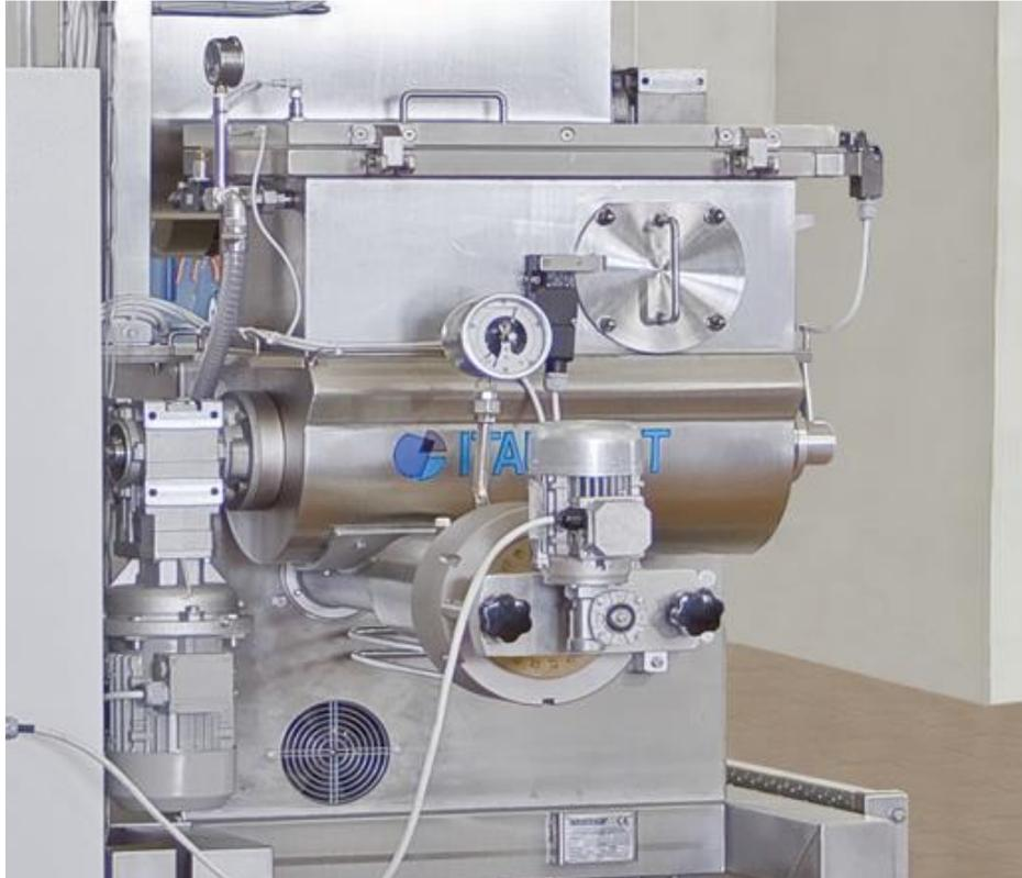
*Slika 4. Oprema za vakuumiranje tjestenine uz ekstruder MAC 220*
