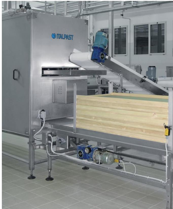
Slika 7. Automatski stroj za punjenje ramica mod. MT
