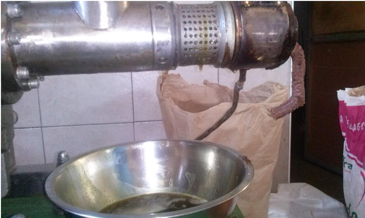
Slika 13: Postupak hladnog prešanja ulja iz sjemenki grožđa
