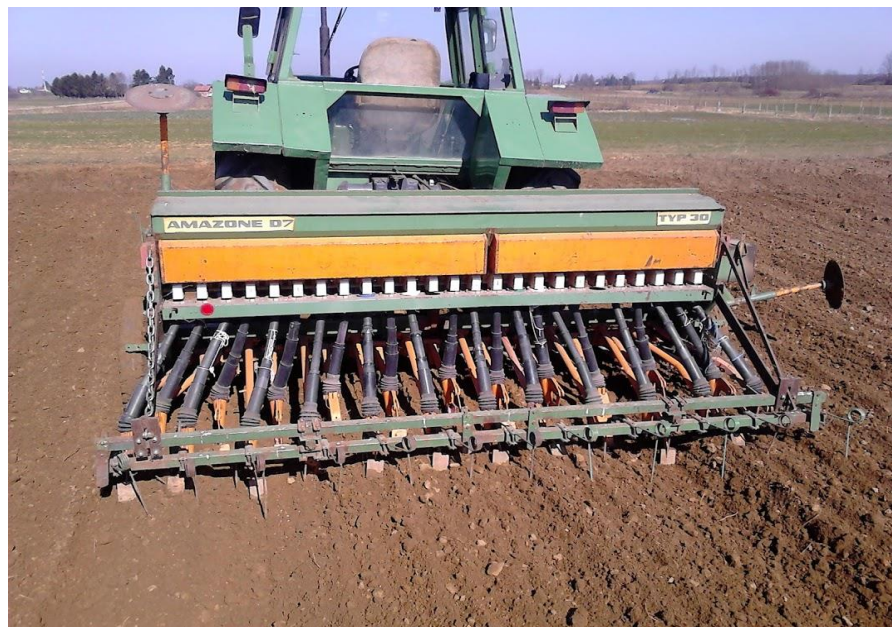
Slika 5. Sjetva zobi na OPG-u Paša sijačicom Amazone D7 TYP 30 (Izvor: V. Miloš)
