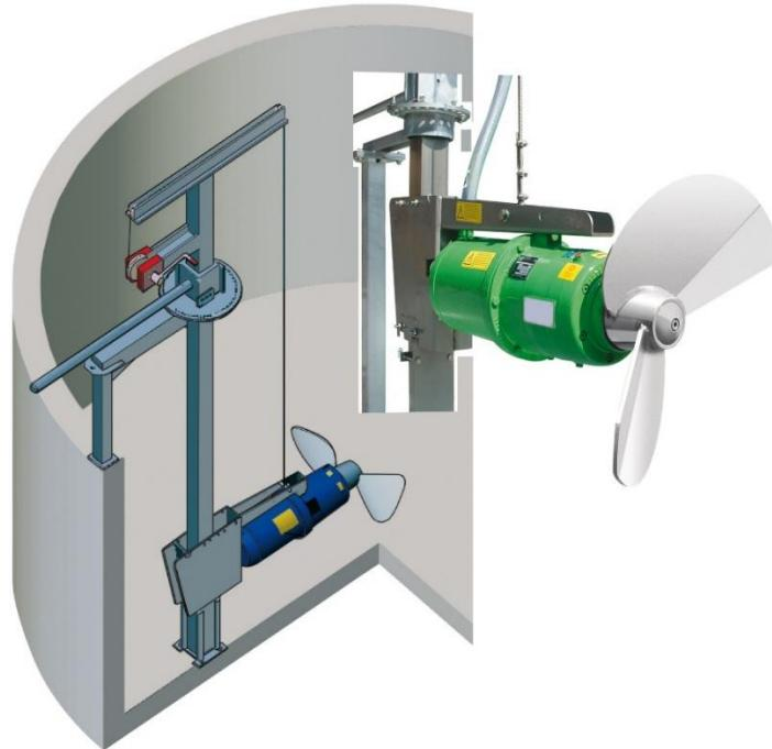
Slika 6. Shematski prikaz miješanja gnojovke stabilnim uredajem
