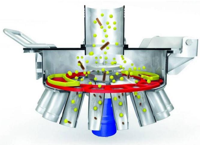
Slika 34. Shematski prikaz rada sklopa za raspodjelu gnojovke
