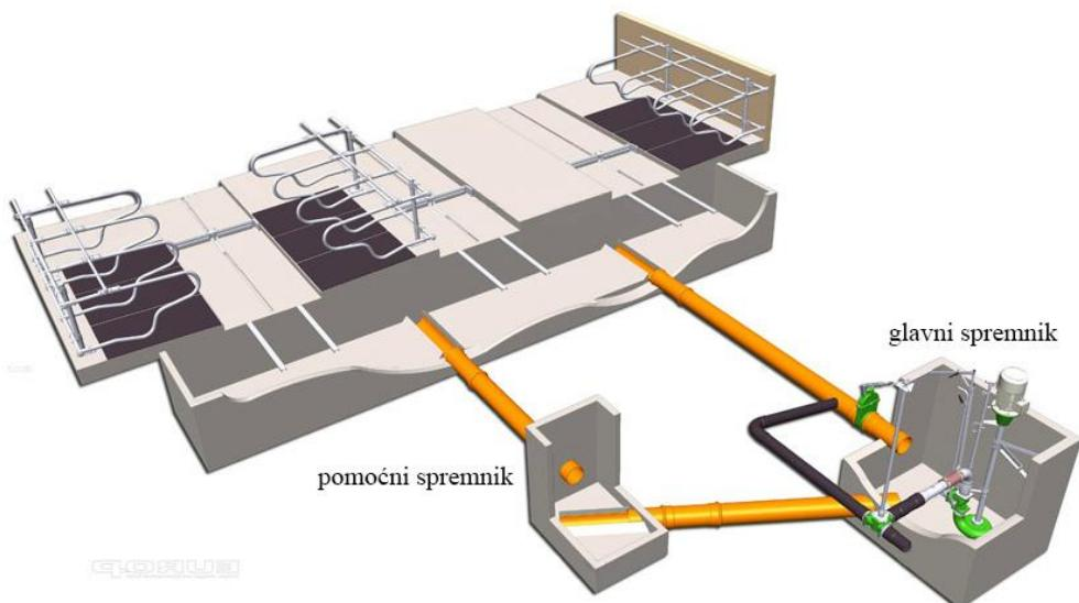
Slika 4. Shematski prikaz pomoćnog i glavnog spremnika
