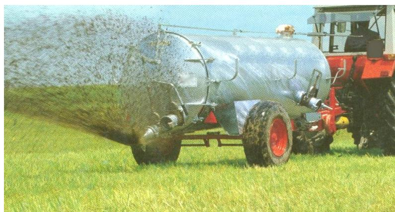
Slika 11. Prikaz uređaja za raspršivanje gnojovke
