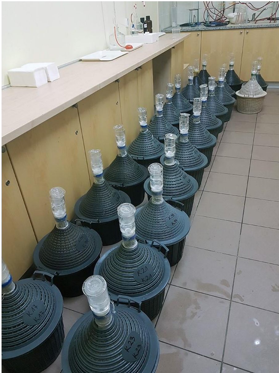
Slika 4. Proces alkoholnog vrenja u bocama od 15 litara (Snimio: D. Kamenjak)
