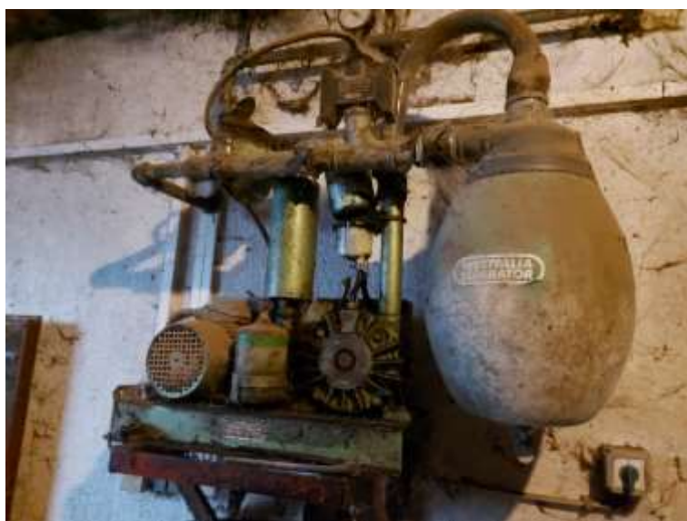
Slika 11. Pogonska jedinica muznog uređaja Westfalia
