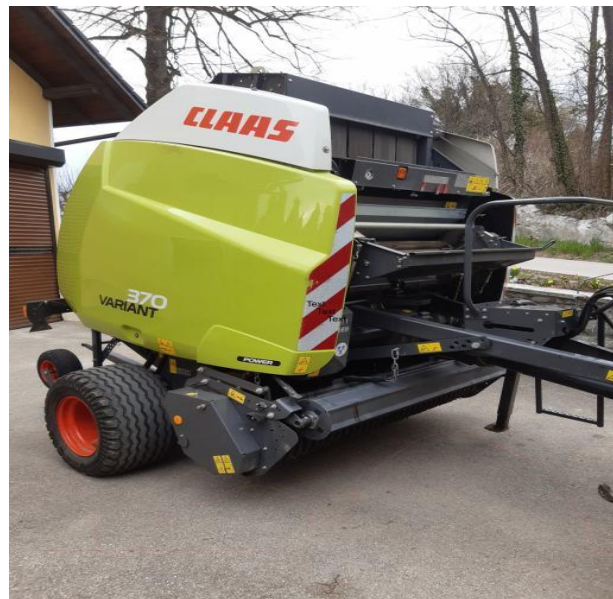
Slika 15. Preša za valjčaste bale s elastičnom komorom (Claas).
