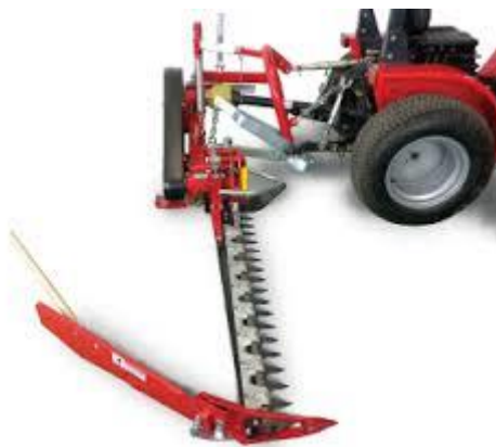
Slika 1. Oscilirajuća kosilica s prstima.
