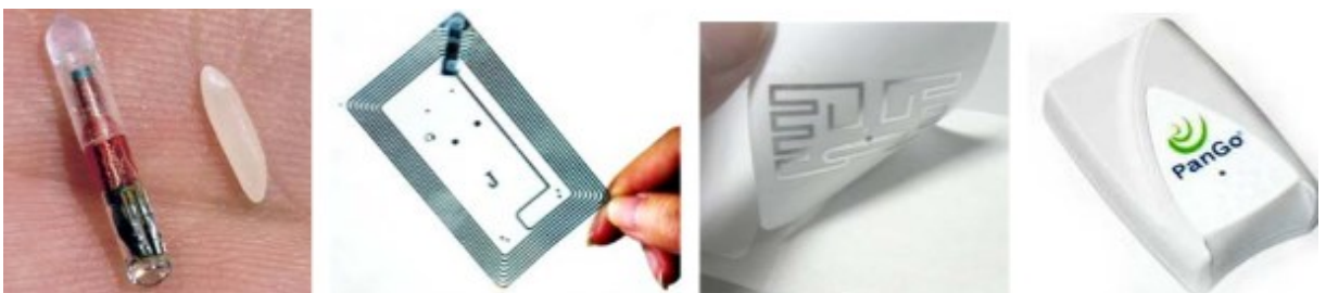
Slika 4. Primjeri RFID transpondera (LF transponder, HF transponder, UHF transponder, mikrovalni aktivni transponder) [4]
